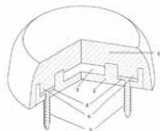
Рис. 1. Фиксатор RFID-метки (аксонометрическая проекция с частичным вырезом):
